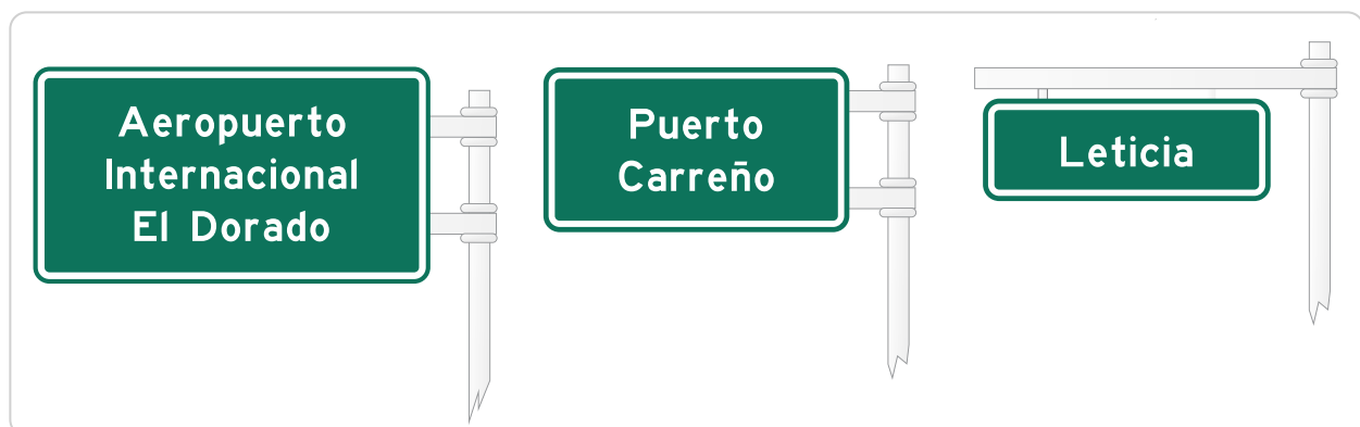
Figura 2.61. Señales de localización
