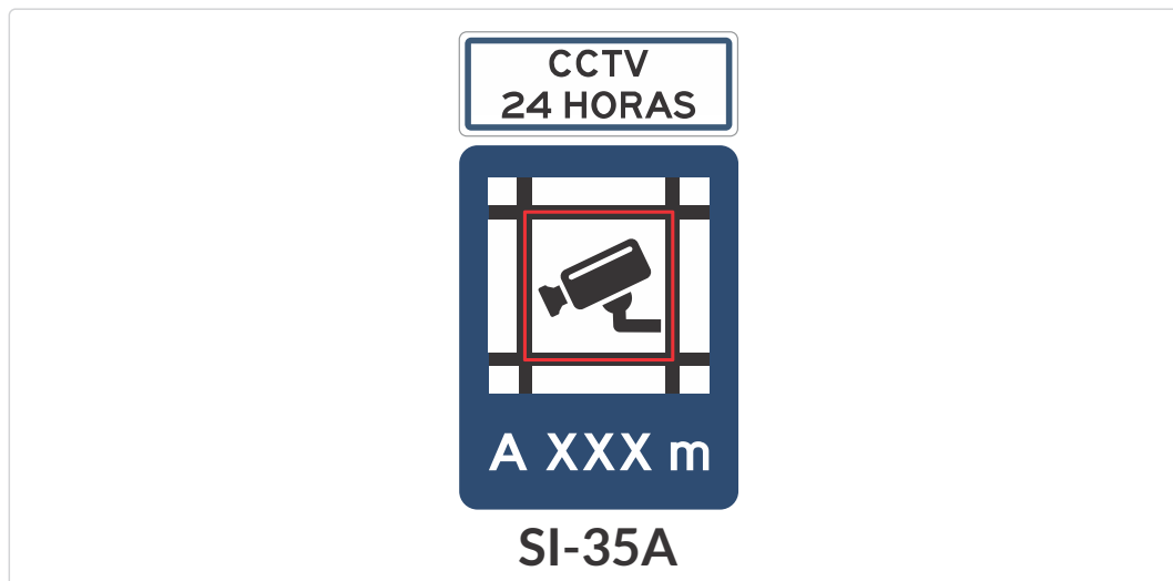
Figura 9-27. Señalización para cámaras en estaciones de peaje
