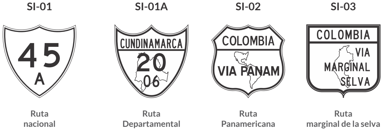
Figura 2-59. Señales de identificación vial
