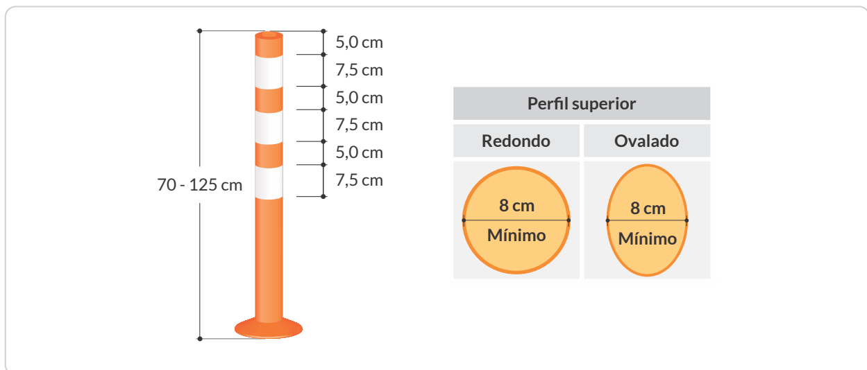
Figura 7-9. Delineador tubular simple
