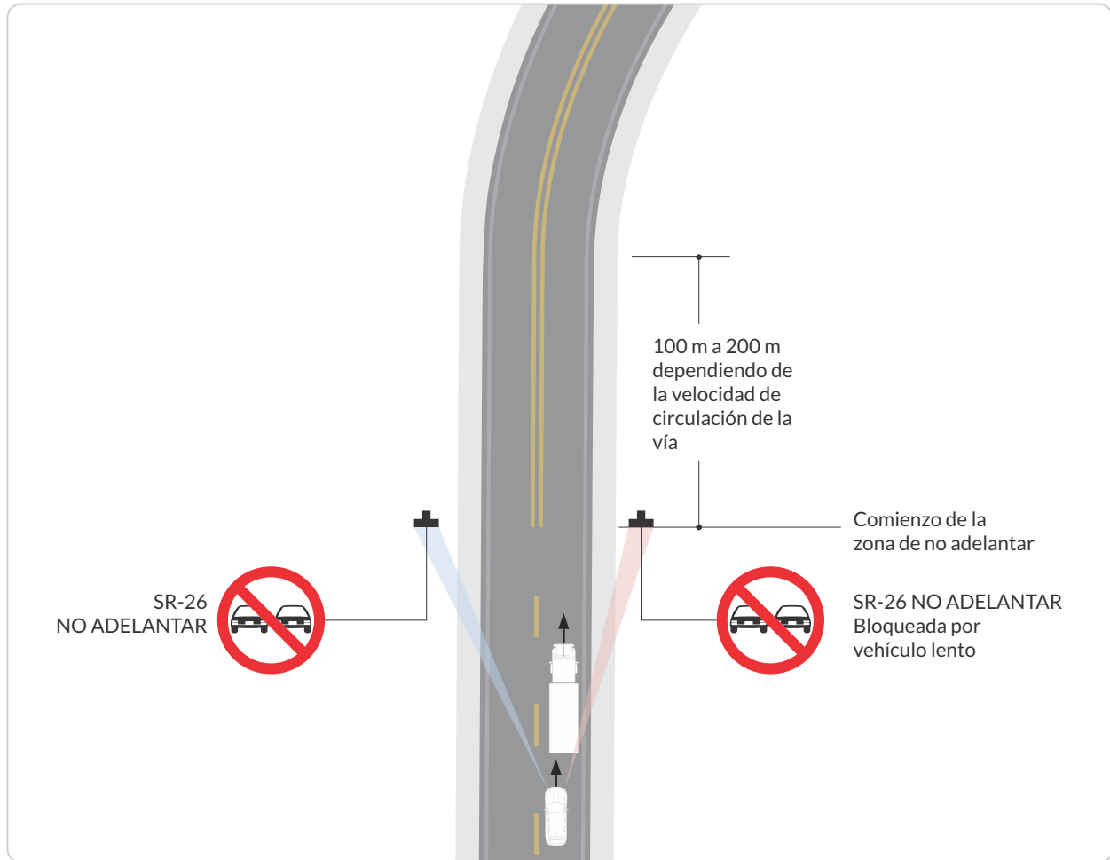
Figura 2-23. Utilización de la señal “No adelantar”
