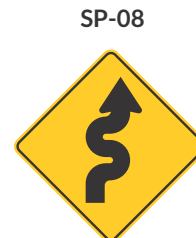
SP-08 Zona de curvas sucesivas la primera a la derecha
