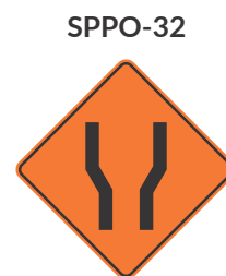
Ensanchamiento simétrico de la calzada
