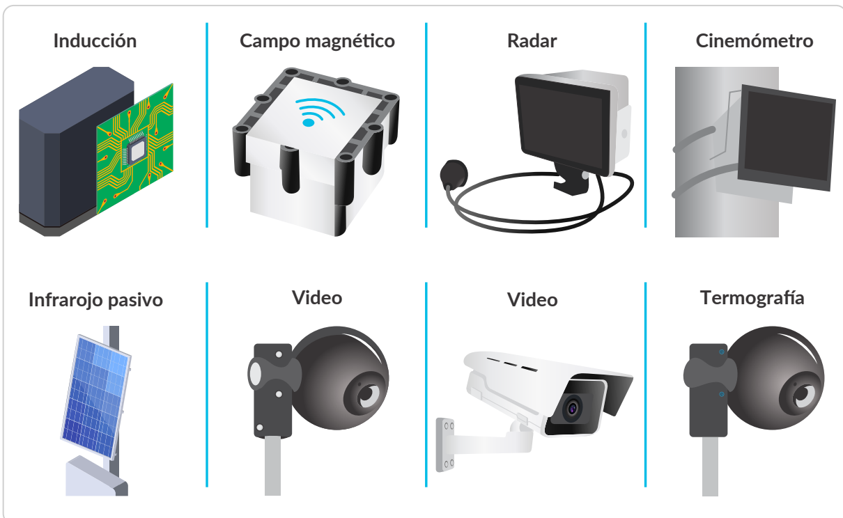
Figura 9-30. Elementos de detección típicos en SAT
