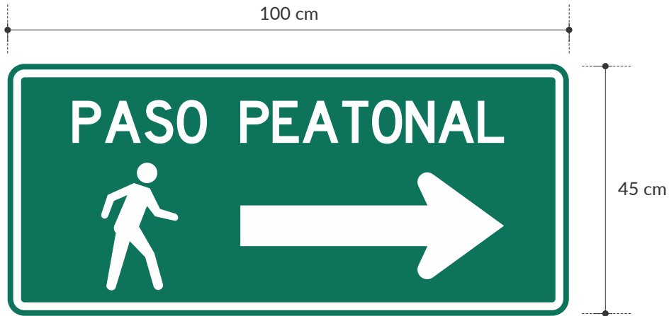
Figura 6-2. Señal SIP-01 PASO PEATONAL
