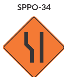
Ensanchamiento de la calzada a la izquierda
