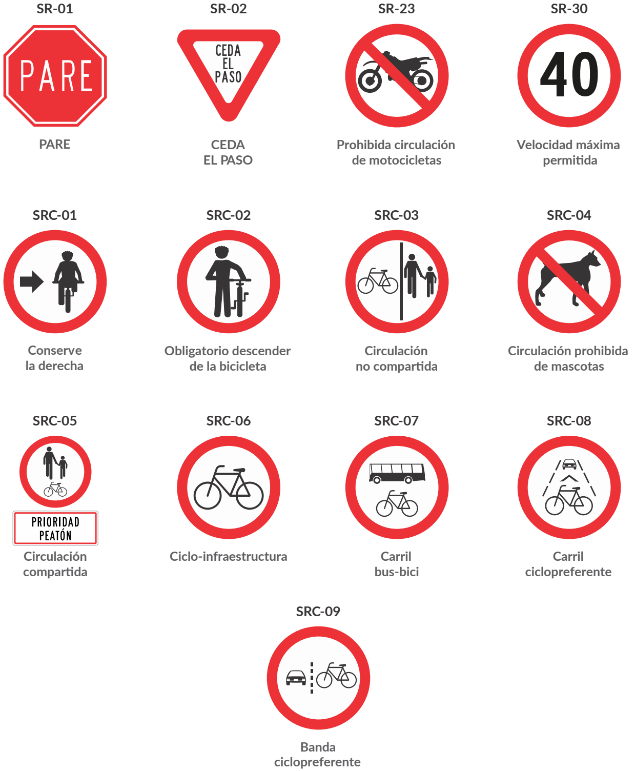
Figura 6-31. Señales reglamentarias para ciclo-infraestructura
