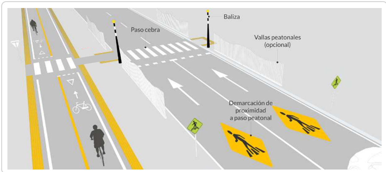
Figura 6-14. Paso cebra en tramo de vía
