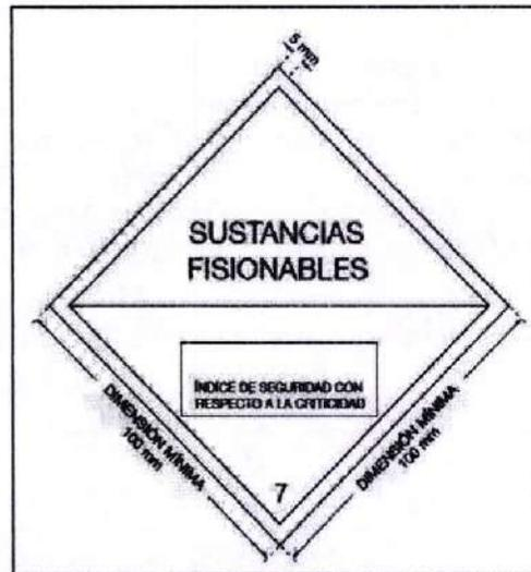
Figura 5: Etiqueta para el ISC. La anchura mínima de la línea dentro del borde que forma el rombo será de 2 mm. El color de fondo de la etiqueta será blanco y los caracteres y líneas impresos serán negros
